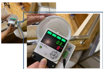
0.3μm/cf 浮遊異物0個のクリーン空気 ※一般環境1000000以上個
